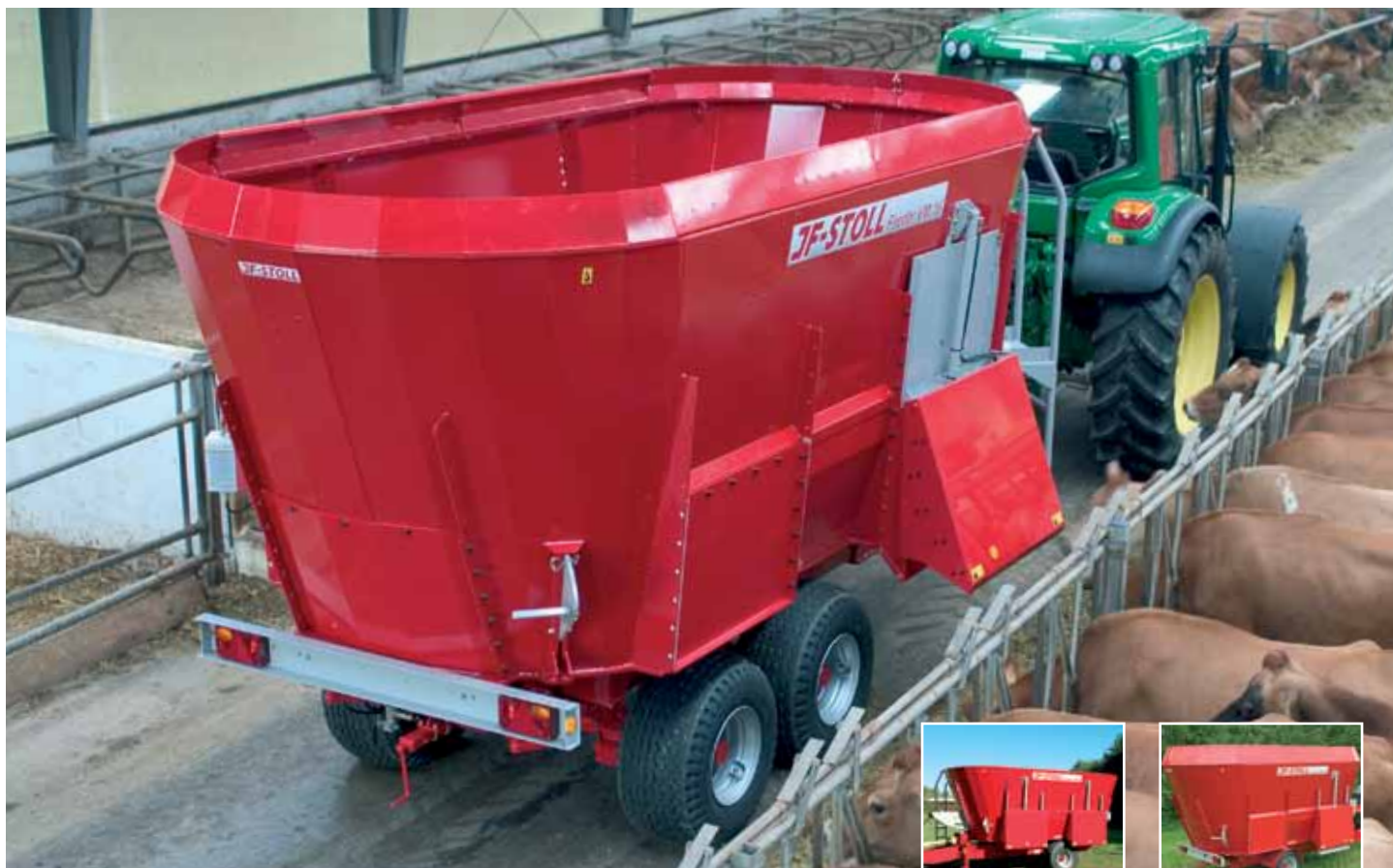
VM 16-2 S monteret med affjedret bogie og luftbremser
