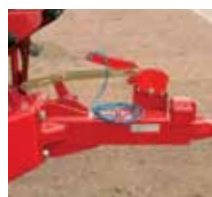
Påløbsbremse (Tyskland) med bremsespærre ved reversering.
