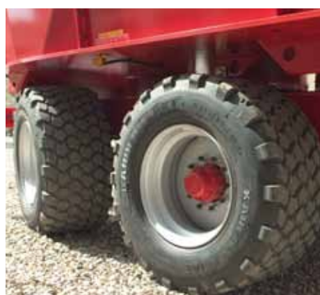
Affjedret bogie, fast eller drejbar bagerste aksel. VM 22-2 B har 1 aksel som standard.
