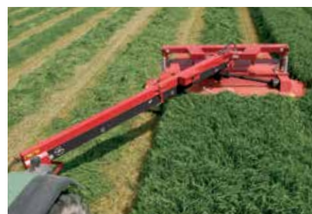
De centertrukne Flex-maskiner er udstyret med en lang, kraftig trækstang.
