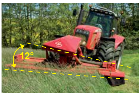
Contour Float - Sideværts hældning på 12°
