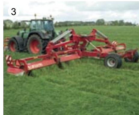
JF-STOLL har udviklet det første bugserede triplesæt, der har en arbejdsbredde på 12 meter.
