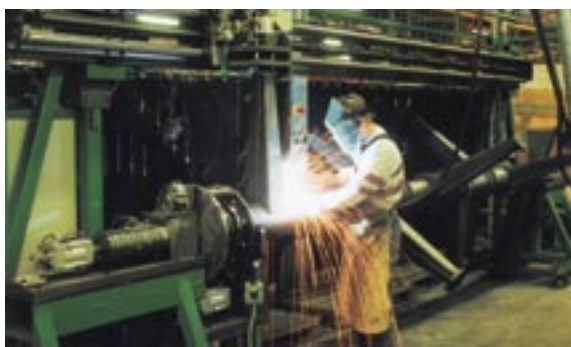
Blanderrotoren, der roterer med kun 6 omdrejninger i minuttet, svejses i et PLC-styret værktøj.
