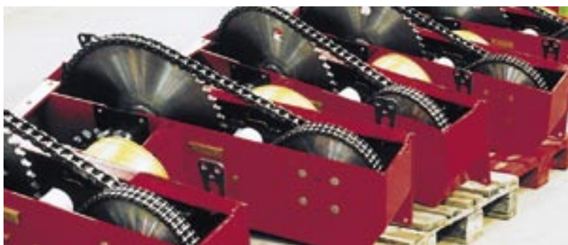
Også gearkassens ekstra kraftige kæder (jvf. amerikansk heavy standard) sikrer lang levetid.
