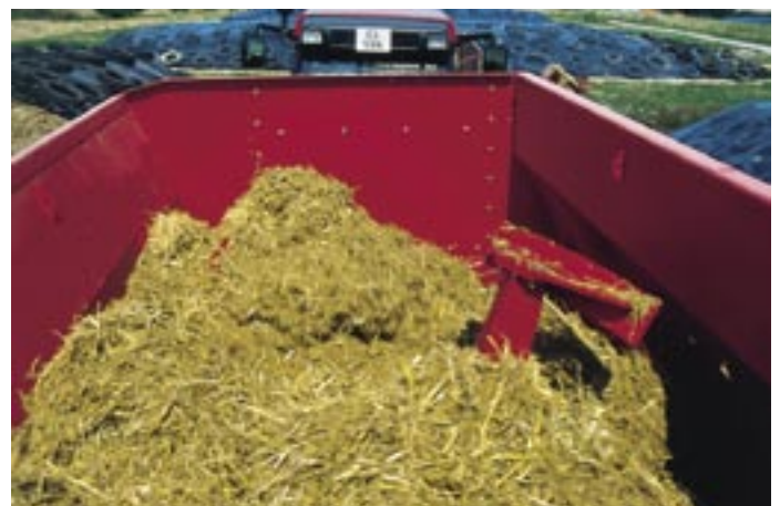
Padlernes form er optimeret, så foderet blandes så skånsomt som muligt. Herved bevares grov-strukturen, og den jævne blandingsproces sikrer et lavt kraftforbrug.
