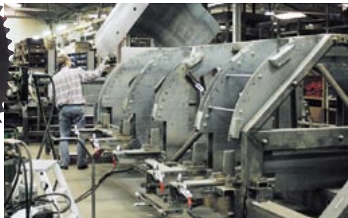
Bundkarret svejses i en gigantisk svejselære. Blandekarrets plader er meget kraftige og slides næsten ikke, fordi de spiralformede padler fordeler trykket over hele overfladen.
