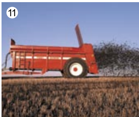
Den robuste staldgødningsspreder MTS fra JF-STOLL, har 2 kraftige lodrette valser for spredning af fast gødning.
