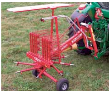
R 285 DS i transport - med både af- og påmonterede rivearme.
