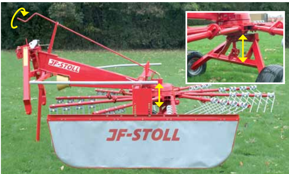
Artikuleret 3-punktsophæng er standard.
