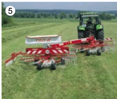
JF-STOLL producerer også rotorriver med arbejdsbredder fra 2,9 til 9 meter.
