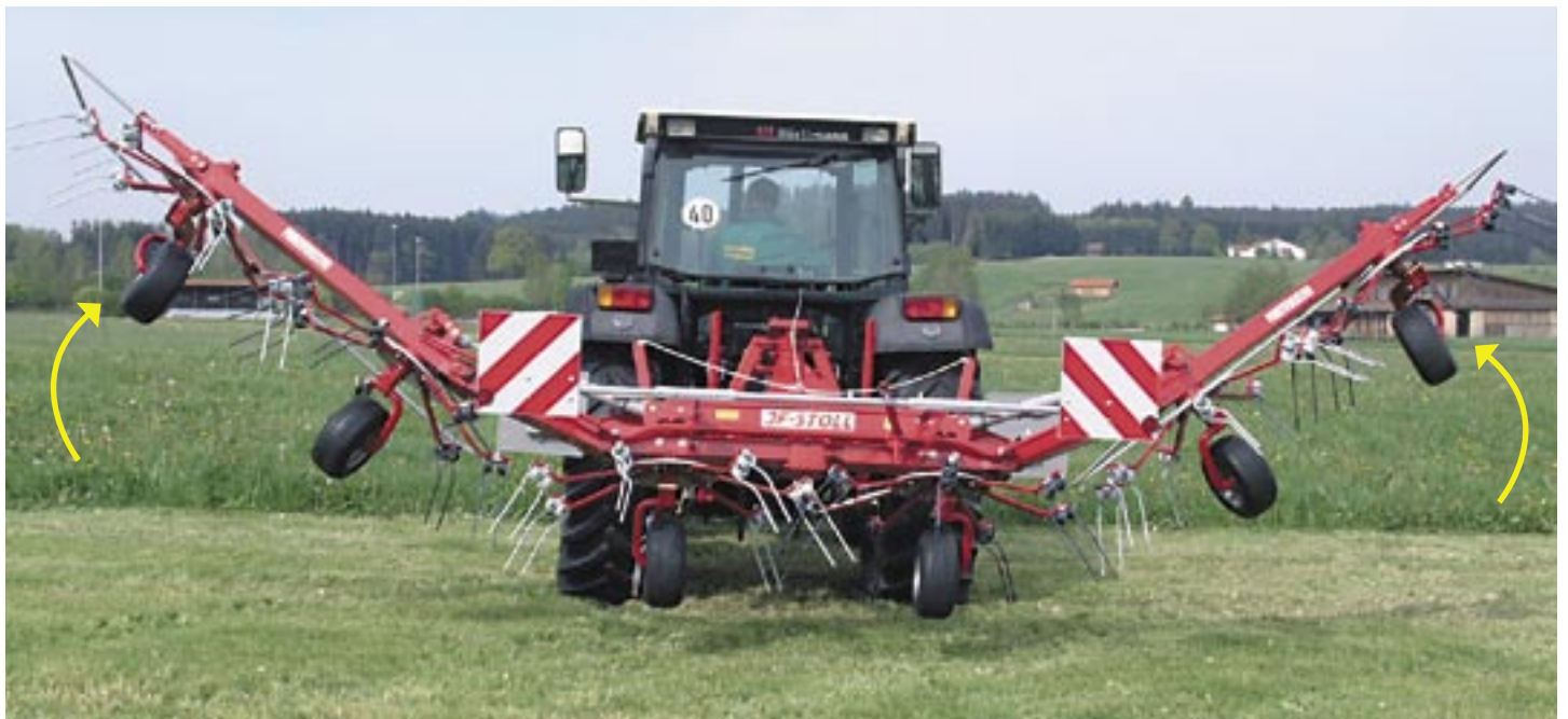
Hurtig løft med mekanisk blokering på Z 765 Pro
