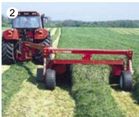
JF-STOLL slåmaskiner findes i arbejdsbredder fra 1,7 m til 12 m. De kan bredsprede og lægge enkelt- eller dobbeltskår.
