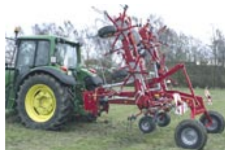
Z 905 Pro A med transportramme, kan transporteres med en mindre traktor end den liftmonterede Z 905 Pro D.
