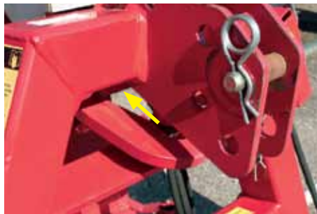
Artikuleret 3-punktsophæng er standard.
