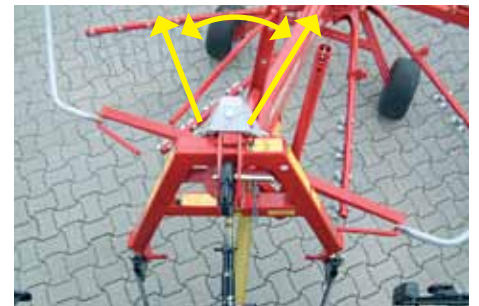
Det artikulerede 3-punktsophæng er udviklet så riven følger traktoren rundt om hjørnerne.
