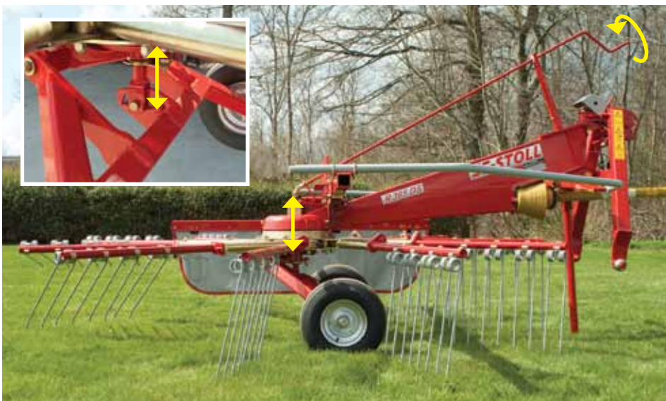
Artikuleret 3-punktsophæng er standard.
