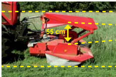
Contour Float - Lodret bevægelse på op til 55 cm
