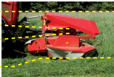
Contour Float - Sideværts hældning på 12°
