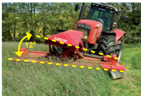
Contour Float - Sideværts hældning på 12°
