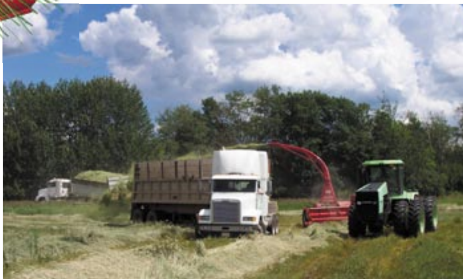
JF-STOLL FCT 1355 er udstyret med en bred og tung nyudviklet 40-knivs snitterotor med høj svinghjulseffekt.
