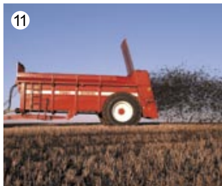
Den robuste staldgødningsspreder MTS fra JF-STOLL, har 2 kraftige lodrette valser for spredning af fast gødning.
