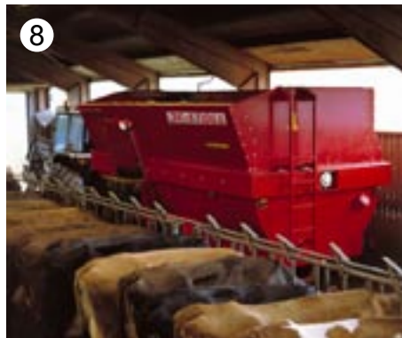
JF-STOLL har stor erfaring i produktion af fuldfodervogne der blander efter padle-princippet.
