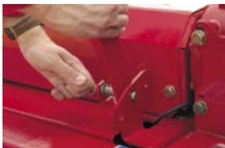
Indstilling af crimpningsgraden på PE-crimperen sker uden brug af værktøj.
