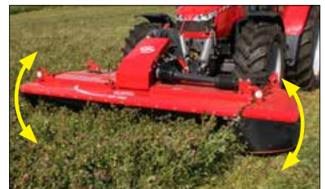
Den bevægelige topramme sikrer en perfekt terrænfølgning.
