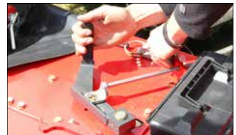
Indstilling af skårrullerne foregår let og hurtigt via et håndtag på SMF.
