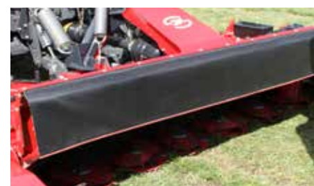
Nem og hurtig adgang til SMF knivbjælken, ved at den forreste dug kan klappes op.
