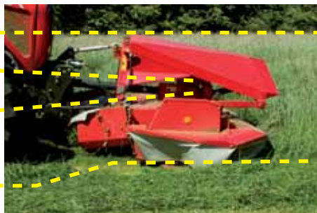
Lodret bevægelse Contour Float giver mulighed for en lodret bevægelse på op til 55 cm.
