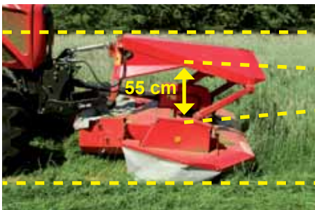
Lodret bevægelse Contour Float giver mulighed for en lodret bevægelse på op til 55 cm.
