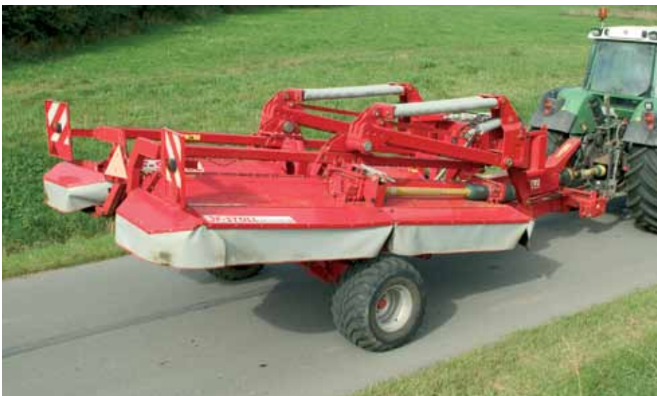
I transportstilling er GXT kompakt med en transportbredde på kun 3 m og en lav transporthøjde, der sikrer et godt overblik.
