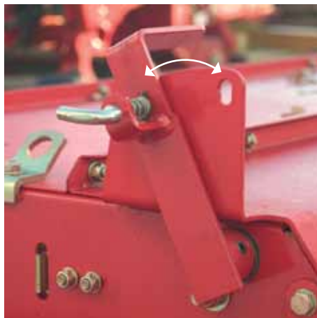
På GX 9005 SM aktiveres Top Dry ved hjælp af et praktisk håndtag - uden brug af værktøj.
