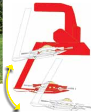
Contour Float - Knivbjælken vipper frem og tilbage (16°), så den holdes parallelt med jorden i bakket terrænet.
