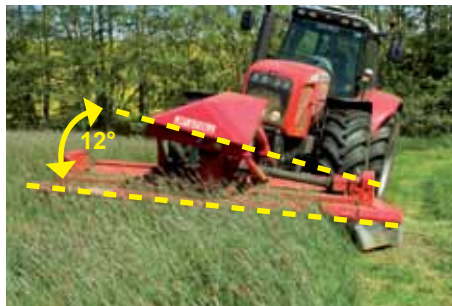
Sideværts hældning Contour Float giver mulighed for en sideværts hældning på 12°.
