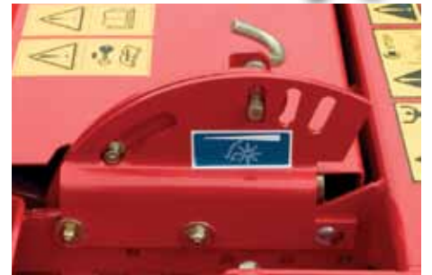
Indstilling af crimpningsgraden på PE-crimperen sker uden brug af værktøj!
