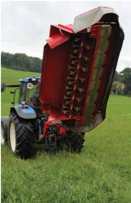
GXS-P modellerne er udstyret med JF-STOLL's stærke og effektive PE-finger-crimper.
