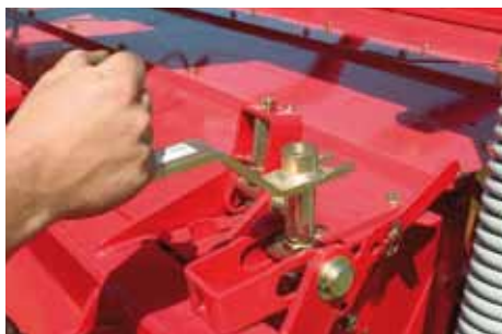
Indstillingen af crimper, Top Dry og stubhøjde er placeret ved siden af hinanden.
