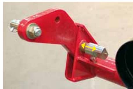
Fjederlås holder "Top Safe lasker", hvilket letter monteringen på traktor. Udløsningskraft i Top Safe kan justeres.
