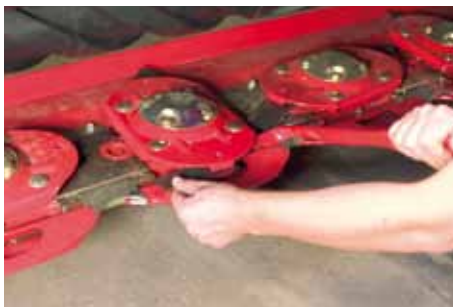
Knivbjælke med Quick'n Safe - for hurtigskift af knive.
