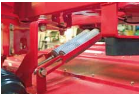
Indstillingen af Top Safe sker uafhængigt af stubhøjdeindstillingen.
