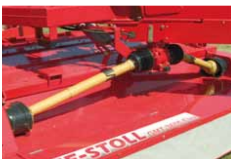
Kraftoverføringen sker via to PTO'er - en til knivbjælke og en til crimper, hvilket giver god vægtfordeling i skærebordet.
