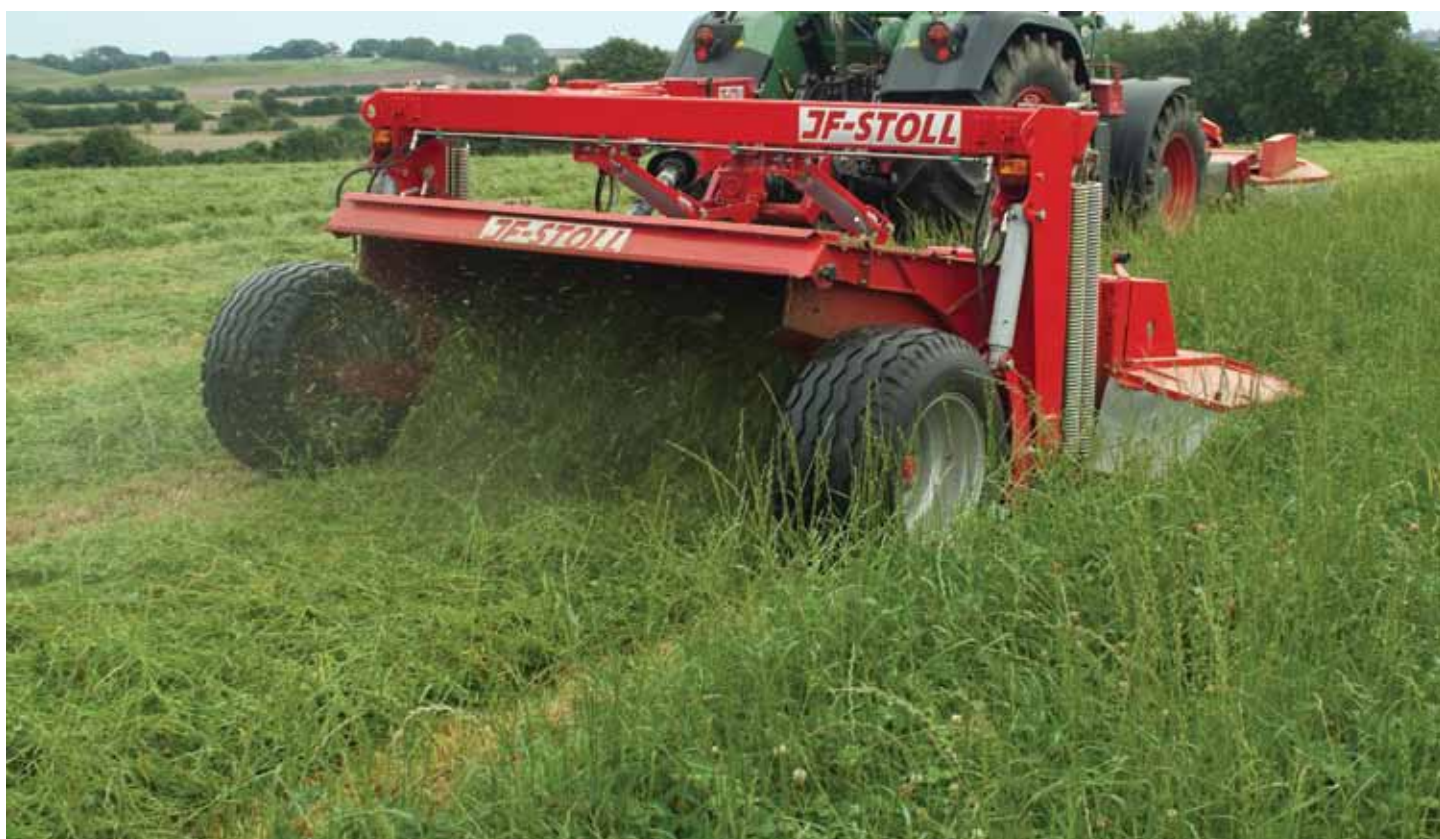
GMT har indbygget Top Dry for effektiv bredspreddning
