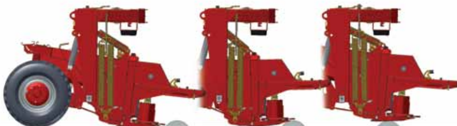
Rammer skivebjælken en sten, trykkes topfjederen automatisk sammen, og maskinen løftes, så den kan glide uskadt hen over forhindringen.
