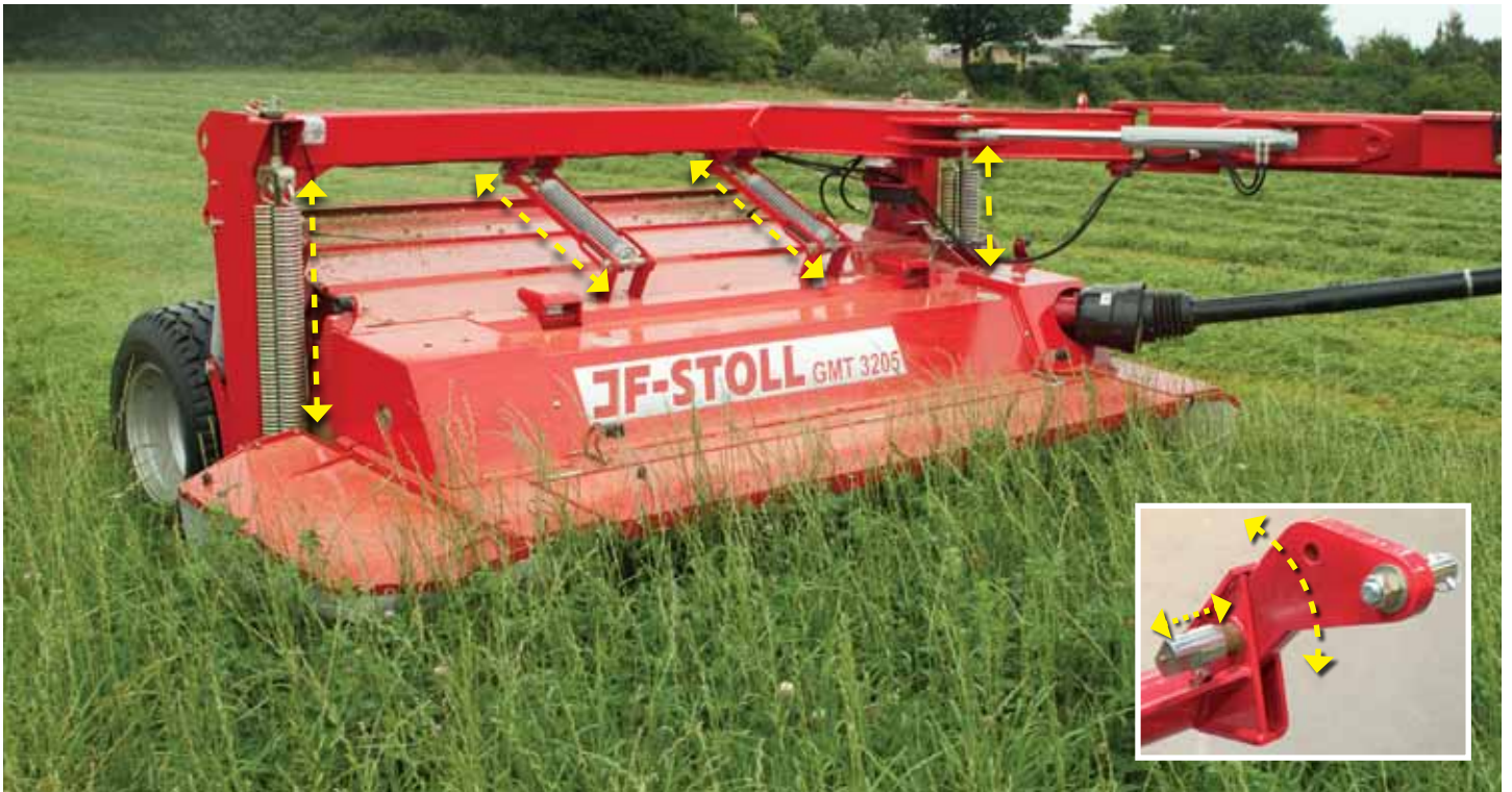
Top Safe består af 4 sidefjedre, 2 topfjedre og en justerbar trækstangsforlænger.
