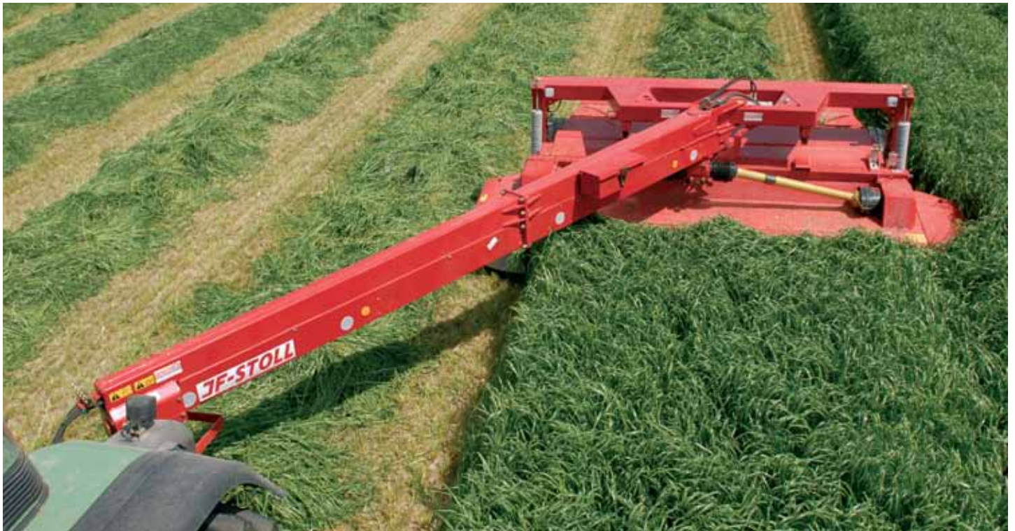
Flex-maskinerne er udstyret med en lang, kraftig, centerplaceret trækstang.
