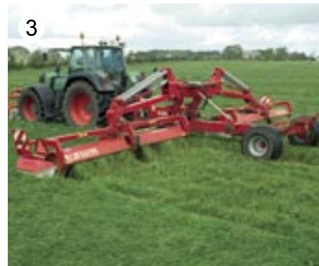
3 JF-STOLL har udviklet det første bugserede triplesæt, der har en arbejdsbredde på 12 meter.
