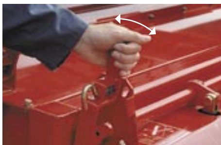
Indstilling af crimpningsgraden på PE-crimperen sker uden brug af værktøj (Ikke GMS 280 og GMS 320).
