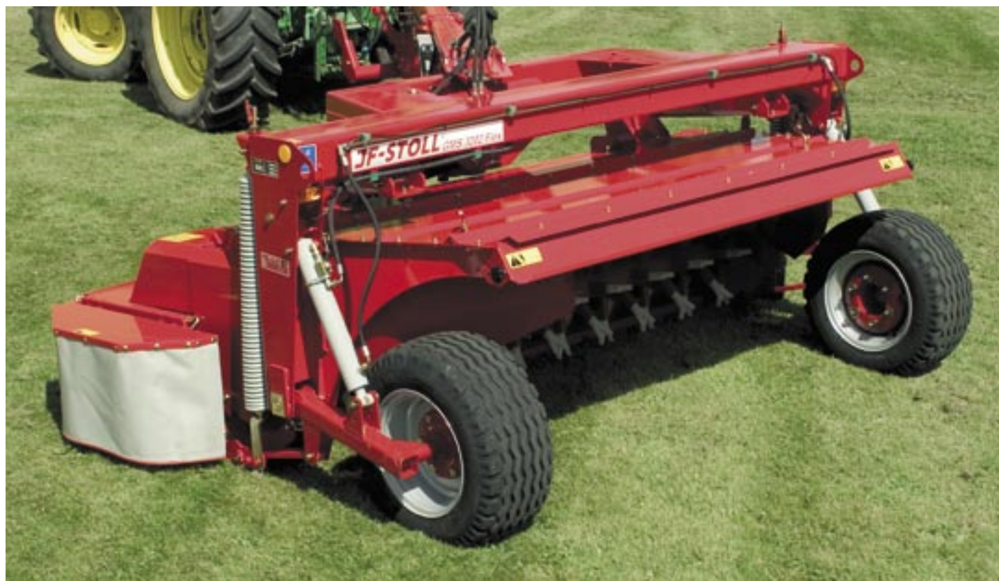
GMS er udstyret med JF-STOLL's stærke og effektive PE-fingercrimper.
