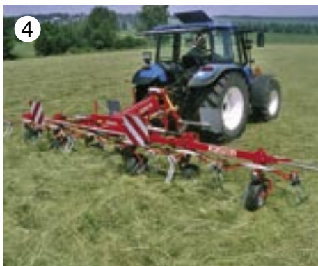
4 JF-STOLL producerer rotorvendere med arbejdsbredde fra 4,5 til 9 m.
