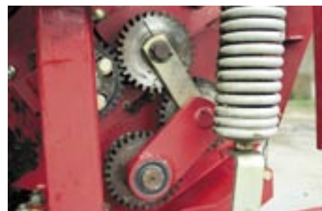
JF-STOLL's patenterede Auto Synchro System sikrer, at crimpervalsernes indgreb altid er korrekt.
