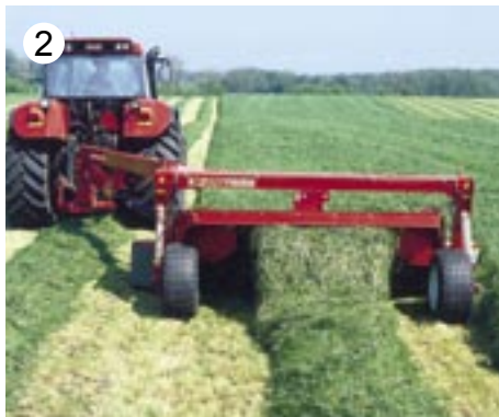
2 JF-STOLL slåmaskiner har en arbejdsbredde fra 1,7 m og til 12 m. De kan bredsprede og lægge enkelt- eller dobbeltskår.
