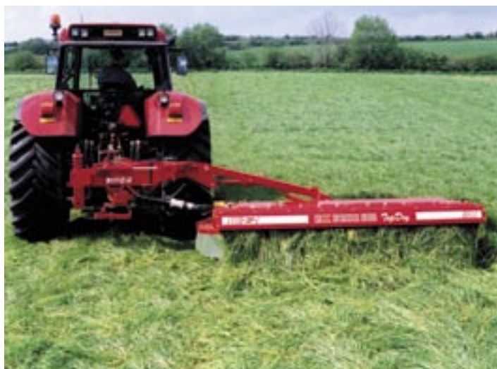
GX-SM Top Dry - er et eksempel på en liftophægt slåmaskine der kan bredspredde. Hermed undgår man risiko for blanding af jord og afgrøde i modsætning til en rotorvender.
