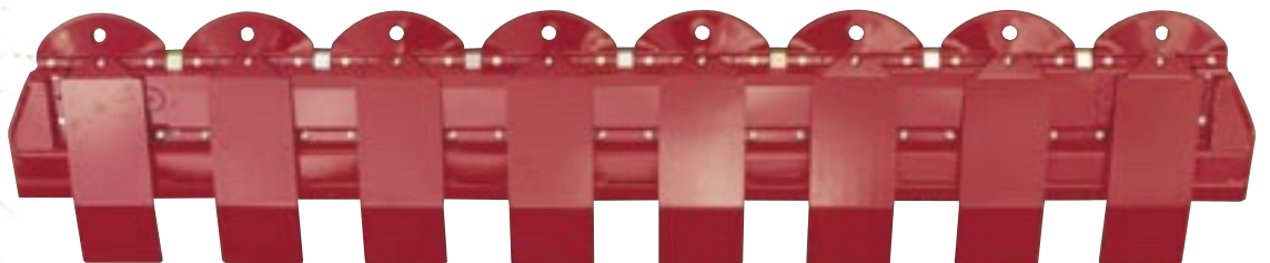
Slæbeskoene har en dobbelt funktion. Dels beskytter de knivbjælken mod slid og slag, og dels hindrer de, at fingercrimperen kommer i kontakt med jorden, og at der bliver hvirvlet jord og sporer ind i ensileringsafgrøden.
