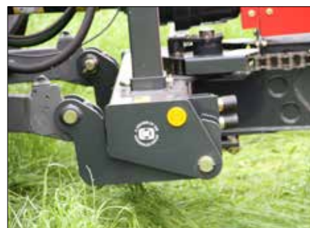
Top Safe sikrer lav stødkraft på knivbjælken ved høj hastighed.
