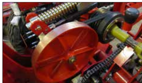
Reverssystemet aktiveres fra traktoren.
