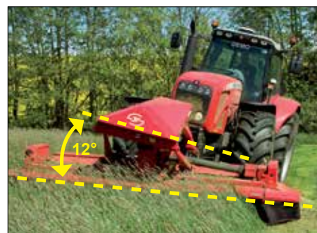
Contour Float - sideværts hældning
