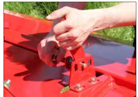
Indstilling af crimpningsgraden på PE-crimperen sker uden brug af værktøj.
