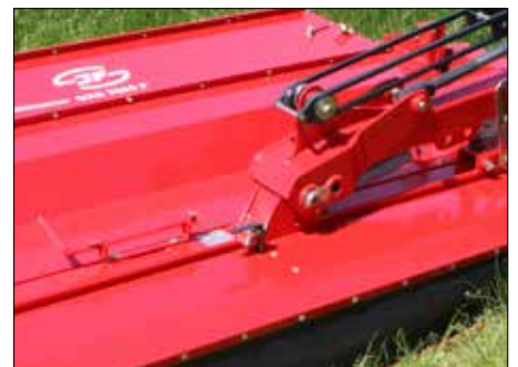
GXS-maskinerne er centerophængt, hvilket sikrer en god terræntilpasning.
