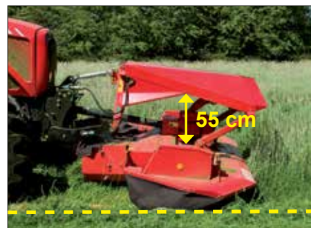
Contour Float - lodret bevægelse (parallelt jævnt terræn)
