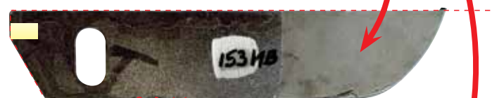
Kvalitetsstål (S355) efter slidtesten
