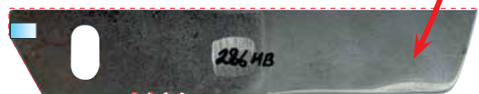
Højstyrkestål (S650) efter slidtesten
