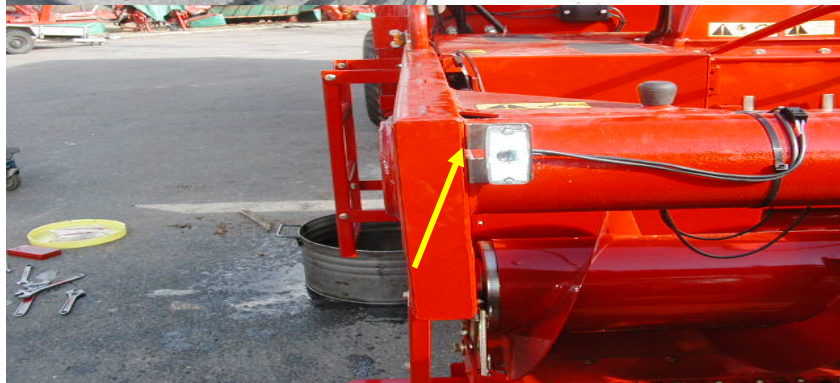
Foto 30: Lys på forsats monteres i de forberedte huller.
