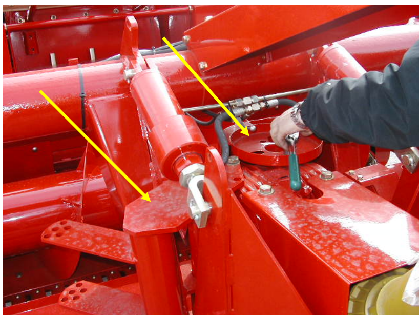
Foto 13: Hjulholder og skærm fjernes fra gearskasse.
