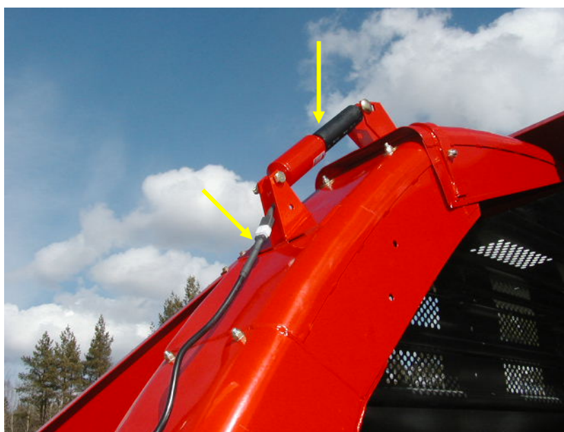
Foto 25: El motor monteres. Kabel monteres.
