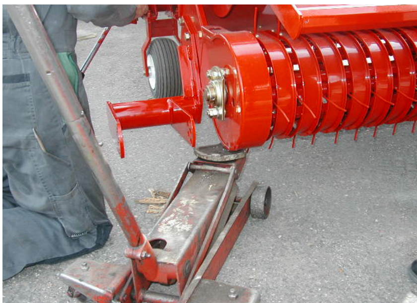
Foto 16: Det kan være nødvendigt at justere huller med donkraft.
