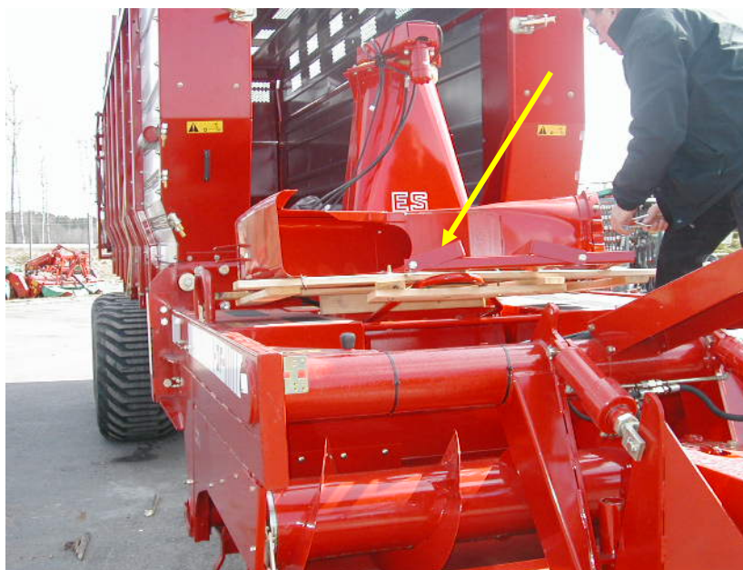
Foto 19: Rør, stige m.m. fjernes fra forsats.
