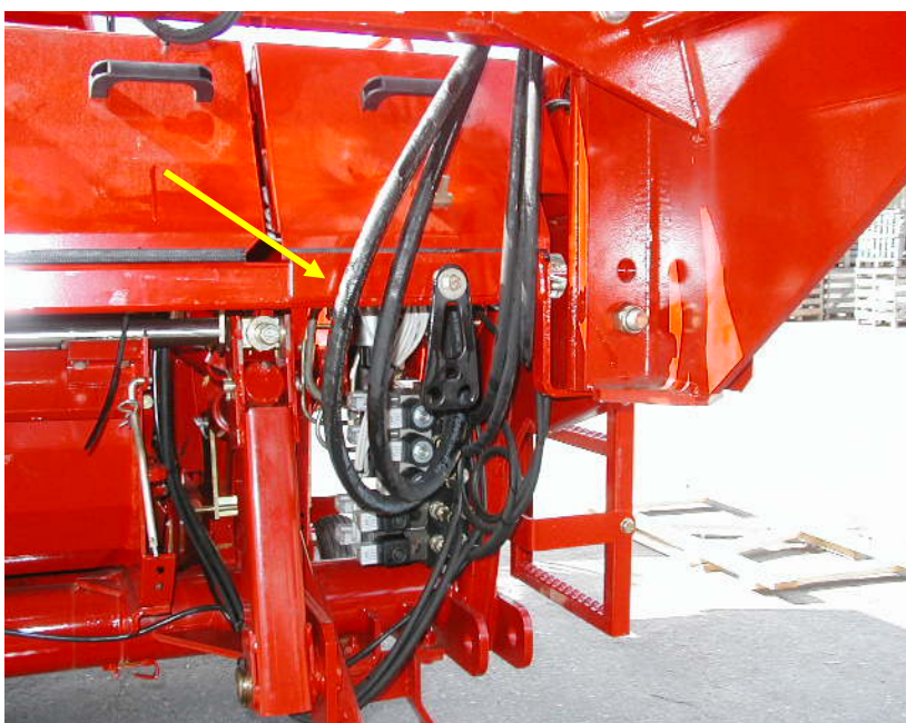
Foto 28: Det er vigtigt at hydraulikslanger placeres som vist på foto af hensyn til skærm.
