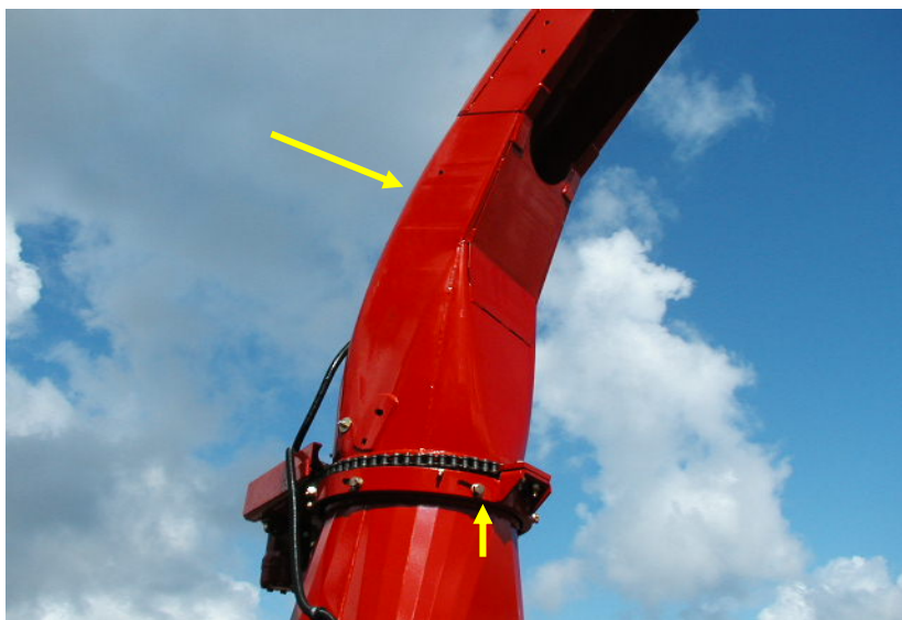
Foto 22: Afgangsrør monteres. Bøjler i ring justeres så rør kan drejes med håndkraft. Dog uden at der er slør i ring.
