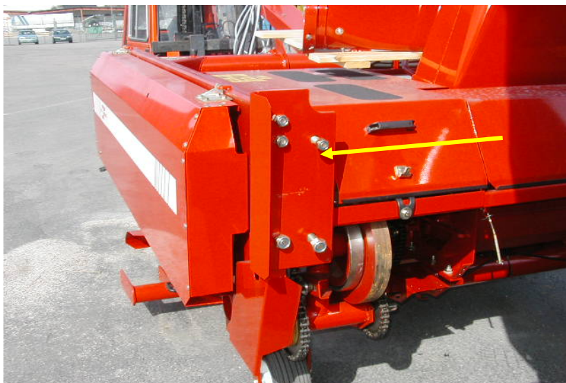
Foto 11: Bolte på forsatsens sammenkoblings flanger fjernes.
