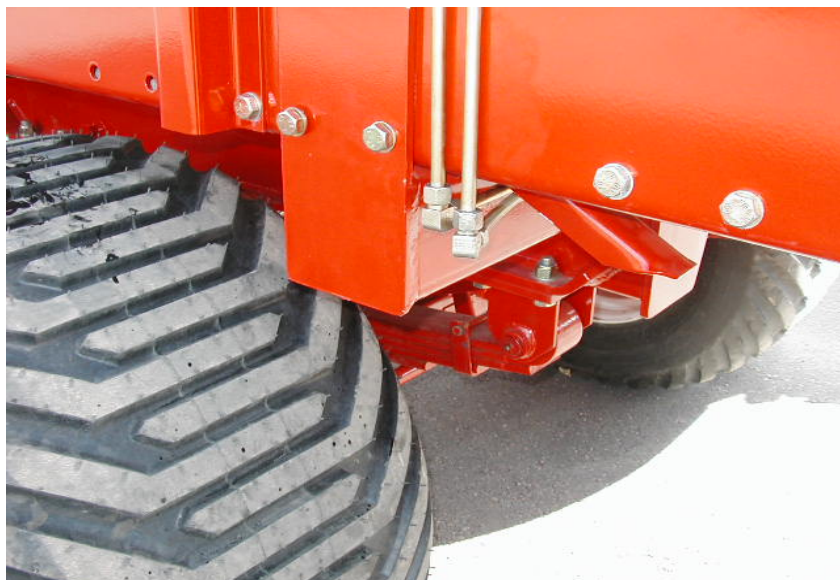
Foto 29: Hydraulik rør forbindes i vognens højre side.
