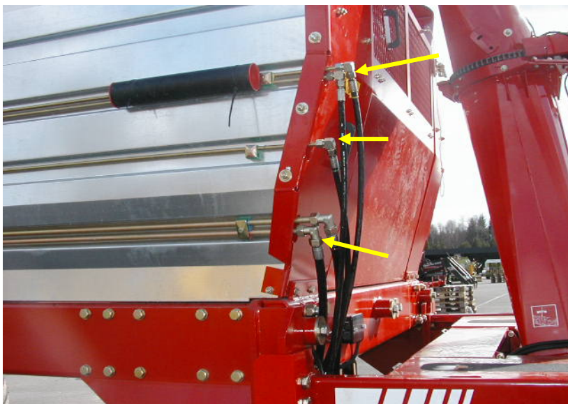
Foto 27: Hydraulikslanger monteres ifølge farvemærkning.
