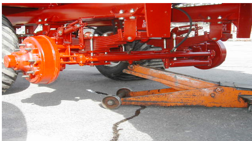
Foto 10: Det kan være nødvendigt at justere højde på hjul nav med donkraft.
