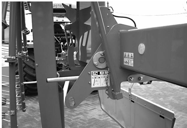
Sperrhaken durch Hydraulikdruck entlasten.
