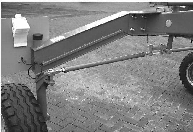
Vordere Warntafeln und Schutzstange rechts auf 3m Breite ausziehen und befestigen. Hintere Warntafeln nach außen weisend befestigen.
